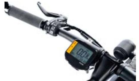
Die Tastatur ist beleuchtet und ermöglicht die Bedienung aller Funktionen.
